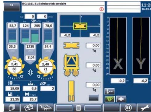
Die Darstellung der aktuellen Lage von Schlitzwandfräsen (Drehrichtung und Neigungen) und die Abweichungen in x- und y-Richtung erlauben dem Gerätefahrer korrigierend über die Ansteuerung von Steuerklappen in den Prozess einzugreifen.
