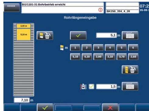
Mit dem Bildschirm für die Erfassung der Bohrröhre behält der Gerätefahrer zu jedem Zeitpunkt die Übersicht über den gesamten Bohrrohrstrang. Durch Setzen eines Schwellenwerts wird er frühzeitig optisch darauf hingewiesen, wenn ein weiteres Bohrröhr einzudrehen ist.
