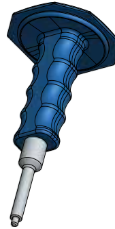
BZ16 Meißelastreiber für Spannstift mit Durchmesser 10 Bit extractor for Roll pin with diameter 10
