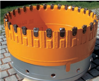
Rohrschuh mit Verschleißstreifen und Verschleißplatten Casing shoe with wear strips and wear plates
