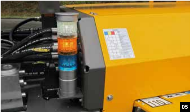
03 Klemmvorrichtung Typ L // clamping device type L 04 Manometerbox // manometer box 05 Signalleuchte für Betriebsarten EN 16228 // signal lights for operation modes EN 16228 06 Funkfernsteuerung // radio remote control
