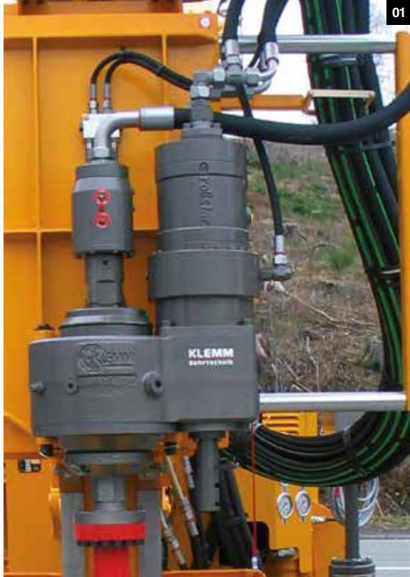
01 Schlittenplatte mit KH 10SF seitlich verschiebbar // side shift slide with KH 10SF 02 Seilkernwinde // Wire-line winch
