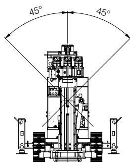
Kinematisch mögliche Schwenkbereiche.
