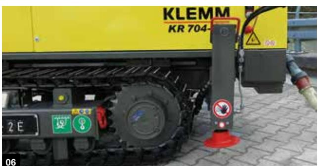
01+02 hyd. spreizbares Raupenfahrwerk // hydr. telescopic undercarriage
