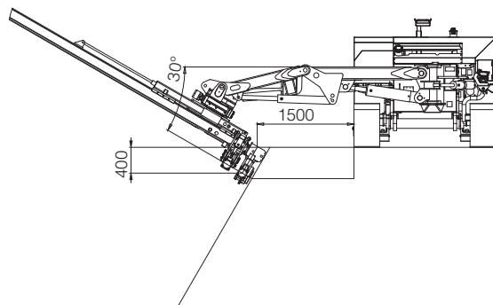
Kinematisch mögliche Schwenkbereiche.
