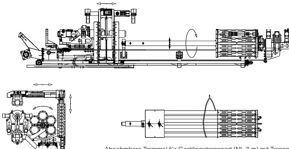
Abnehmbare Trommel für Gestängentransport (NL 3 m) mit Transportsicherung
