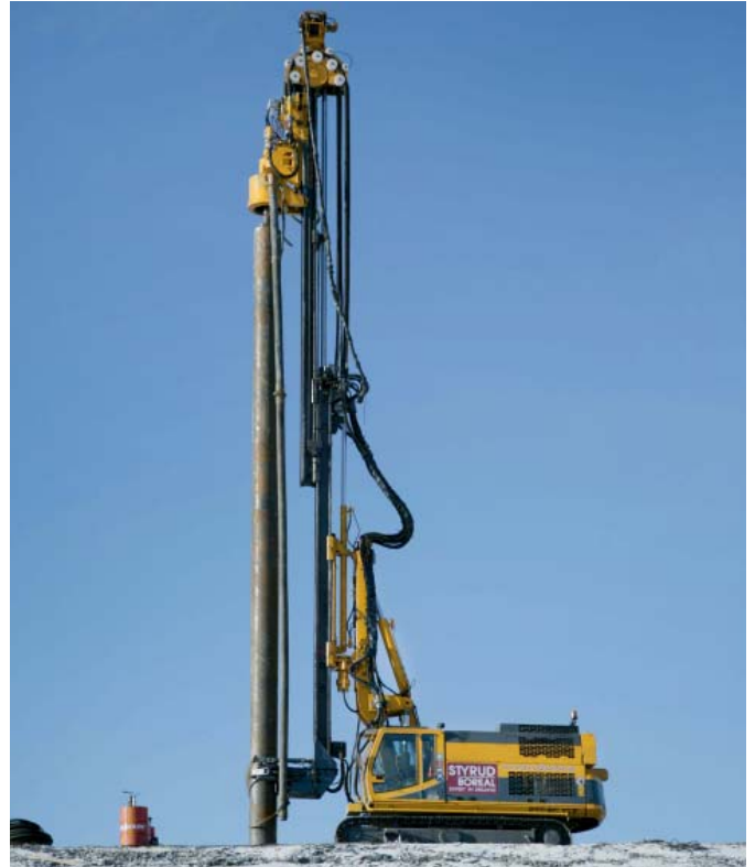
DTH Imlochhammer mit RG 16 T Down-the-hole hammer on RG 16 T
