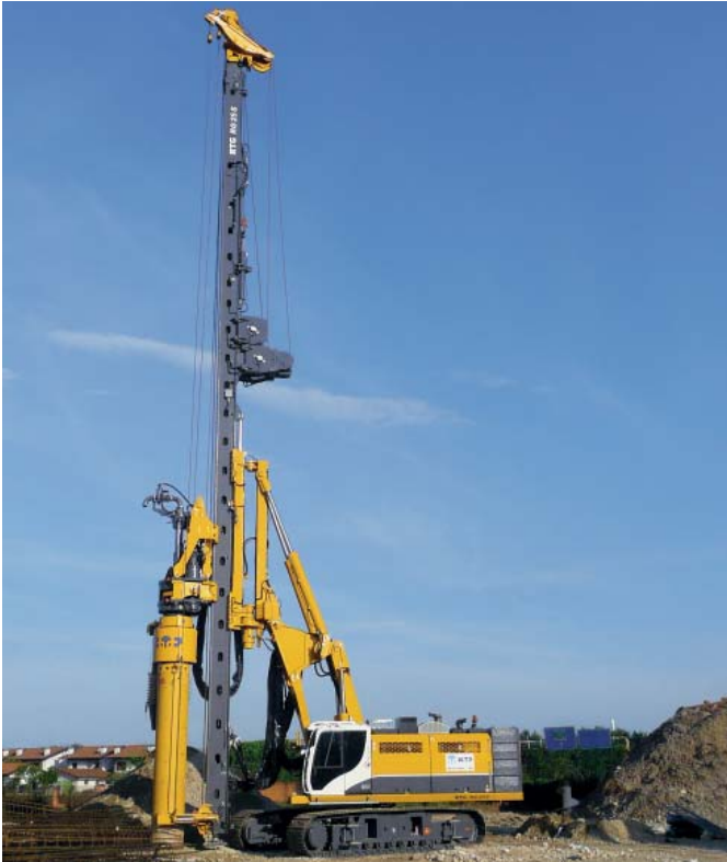
RG 25 S mit Doppelkopfbohrantrieb DKS 150/300 RG 25 S with double rotary drive DKS 150/300
