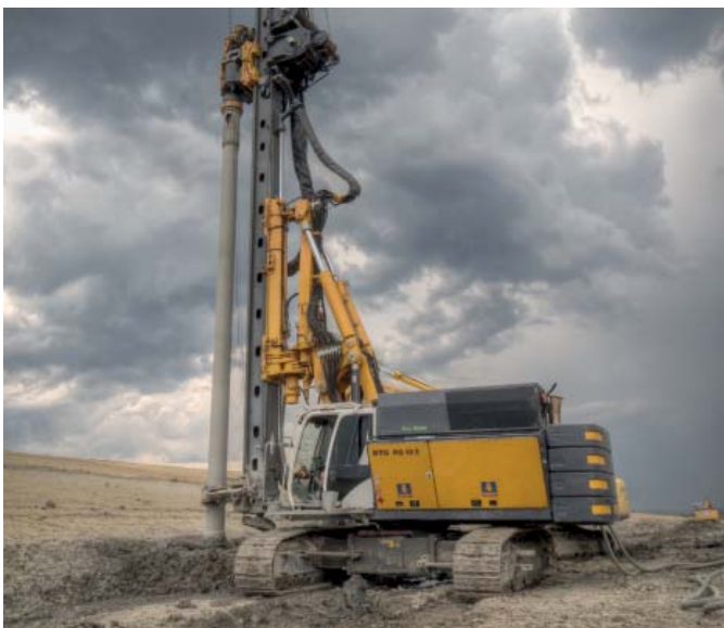
SCM-DH mit Doppelkopfantrieb an RG 18 S SCM-DH with double rotary head on RG 18 S
