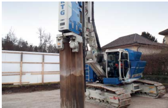
RG 19 T mit MR 150 AVM Doppelklemmzange RG 19 T with MR 150 AVM double clamp
